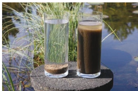
Fot. 1. Właściwości sedymentacyjne. Po 5 min osadzania, osad granulowany (z lewej), osad klasyczny (z prawej)
