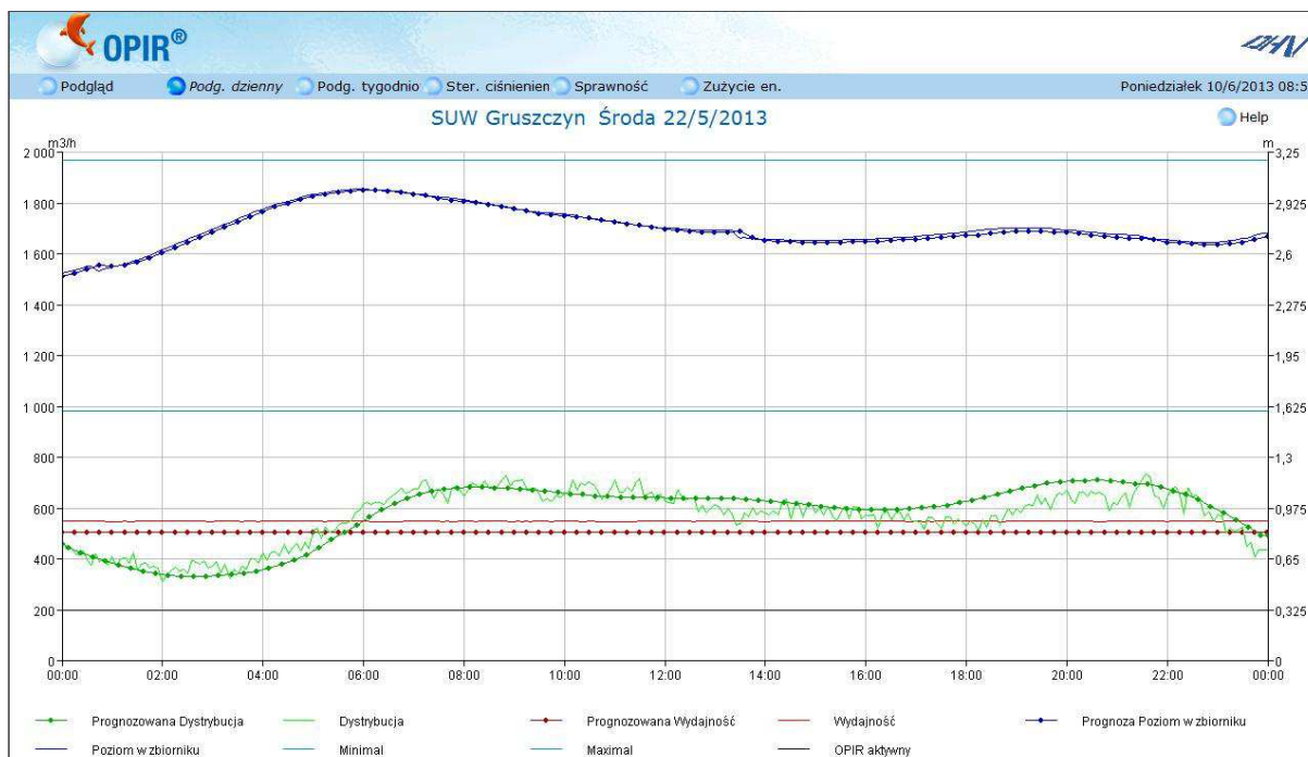
Rys. 3 Przykładowy dzień pracy modelu OPIR na SUW-Gruszczyn
